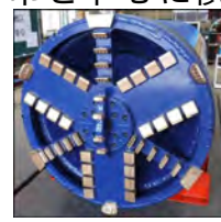
推進工法で使用する掘進機
