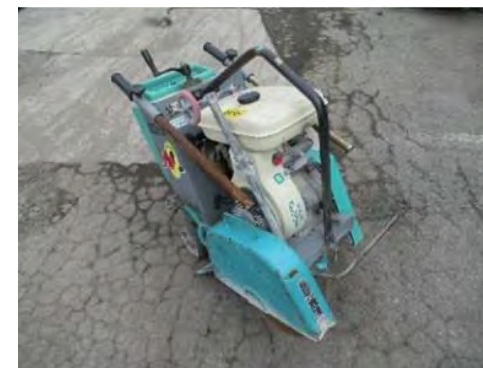
コンクリートカッター
