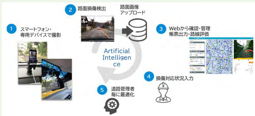
▲AIを活用した画像解析道路損傷検出システム
